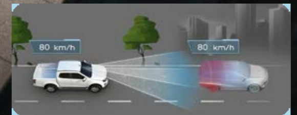
• ระบบควบคุมความเร็วอัตโนมัติแบบแปรผัน ACC (Full Speed Range Adaptive Cruise Control) พร้อมฟังก์ชัน Stop and Go
