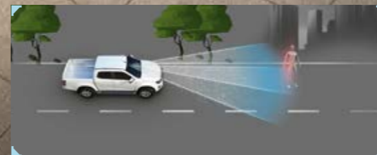
• ระบบแจ้งเตือนก่อนการชนด้านหน้า FCW (Forward Collision Warning) พร้อมระบบเบรกฉุกเฉินอัตโนมัติ AEB (Autonomous Emergency Braking)
